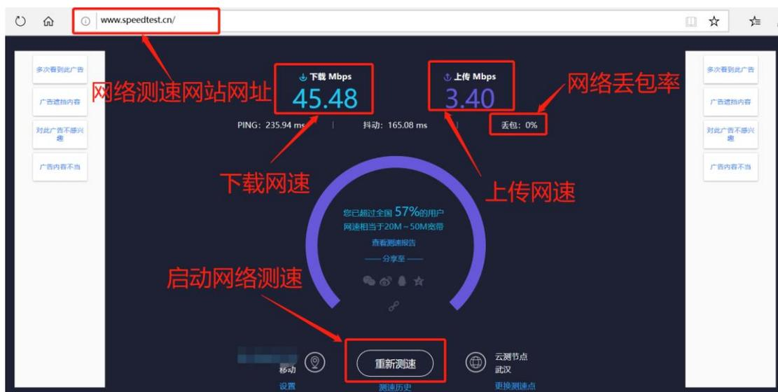
图：www.speedtest.cn 网络测速方法
